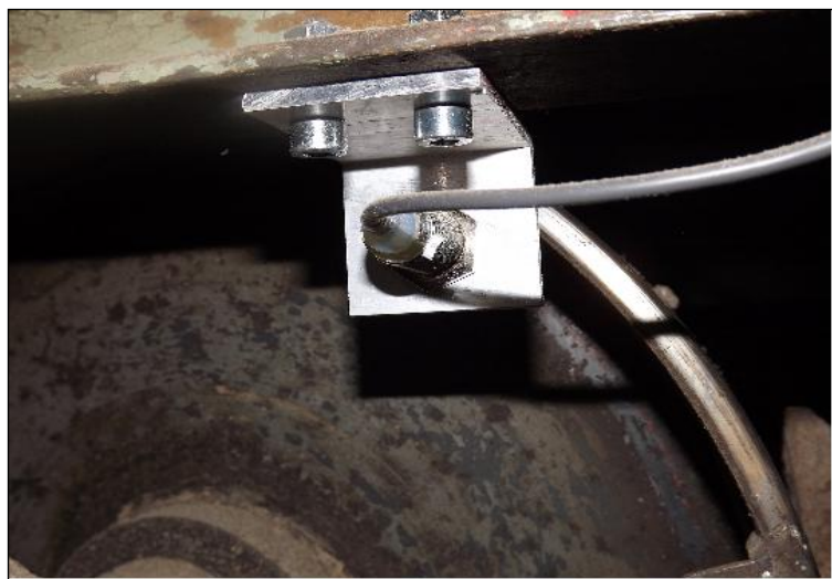
Рис. №3 Датчик Назначение: Предназначен для определения количества оборотов возвратного вала.
